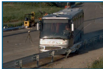
Ensaio TB 51 Ônibus 13.000 kg., a 70 km/h e 20°
