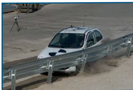
Ensaio TB 11 Carro 900 kg., a 100 km/h e 20°
